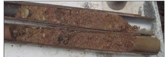
Arenas de la Capa R1 recuperadas en un ensayo de SPT
