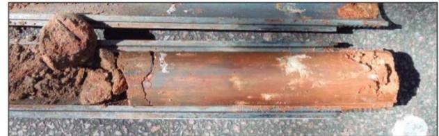
Arenas de la Capa R2 recuperadas en un ensayo de SPT
