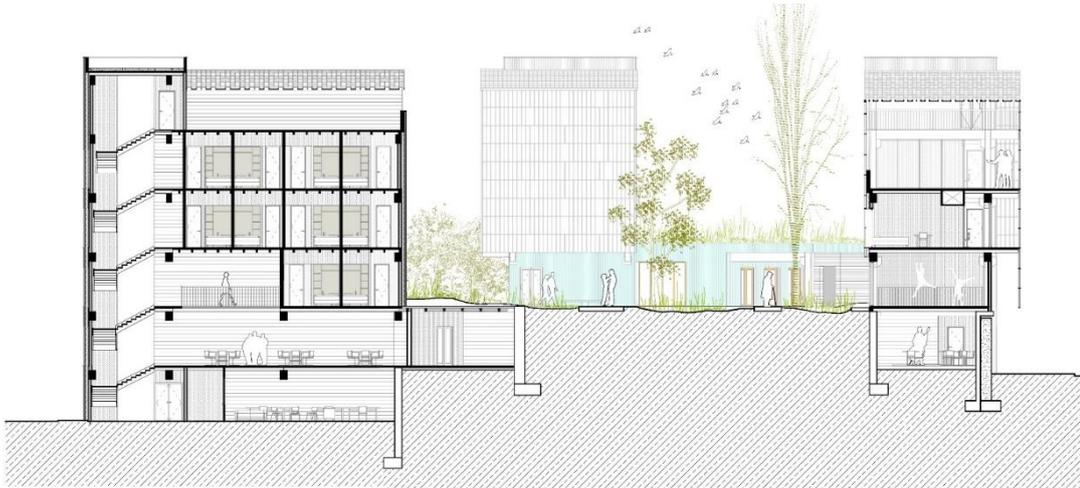
Imagen 39: Sección Longitudinal. El terreno toma un papel de gran valor. La estrategia de contener las tierras y preservar la forma del terreno existente genera la capacidad de tener inercia térmica en las plantas bajas del programa. Documento generado por el autor.
