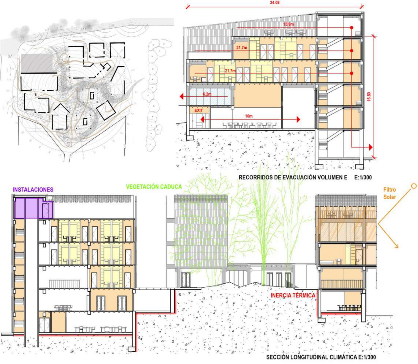
SECCIÓN LONGITUDINAL CLIMÁTICA E:1/300
