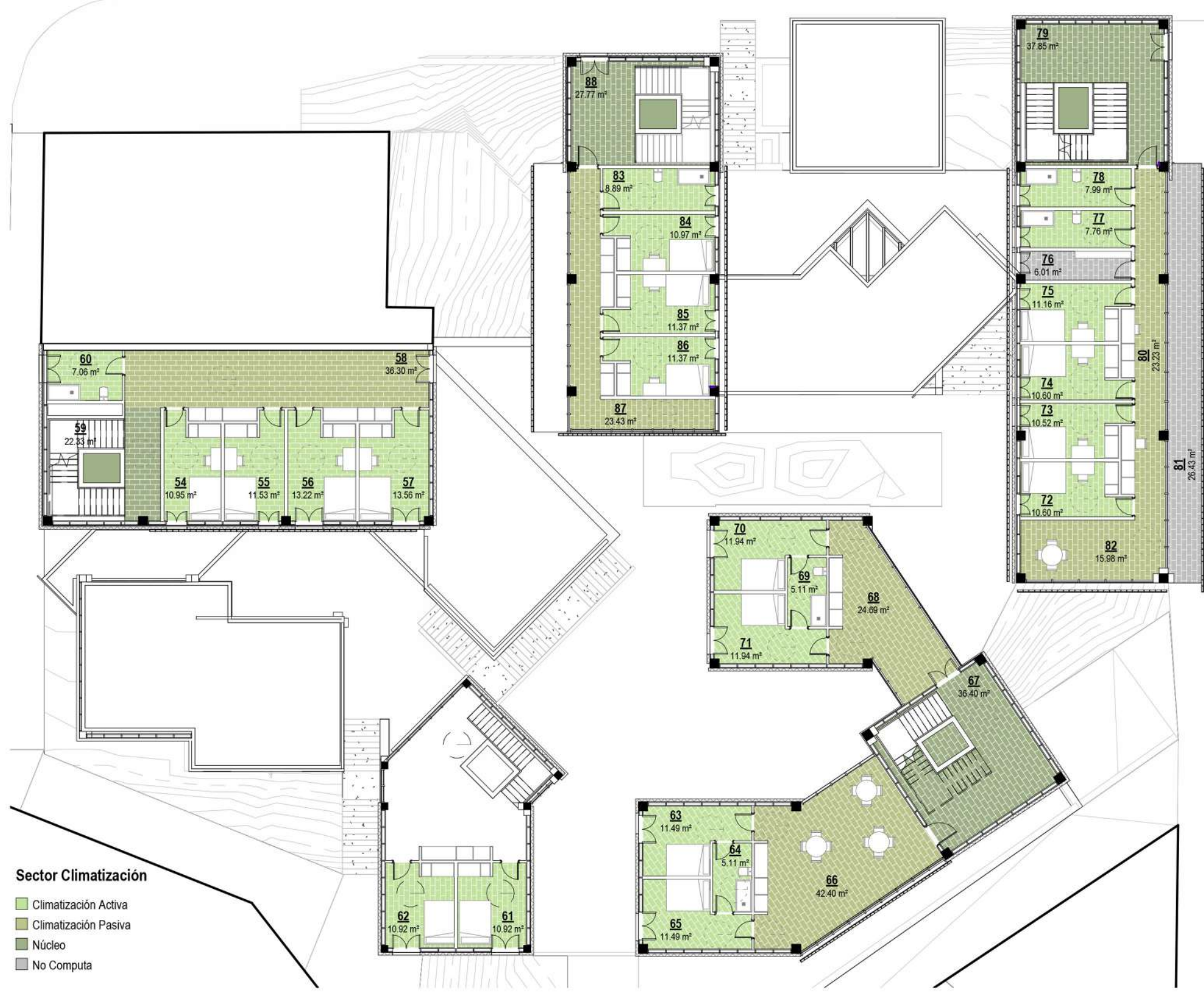
SECTORIZACIÓN CLIMÁTICA - PLANTA TERCERA - E:1/200
